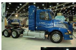
Fot. Ciężarówka Freightliner Cascadia na CNG. Pierwsza ciężarówka z silnikiem gazowym o mocy 400 KM
