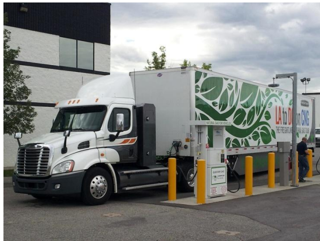
Fot. Ciężarówka Freightliner Cascadia na CNG. Pierwsza ciężarówka z silnikiem gazowym o mocy 400 KM
