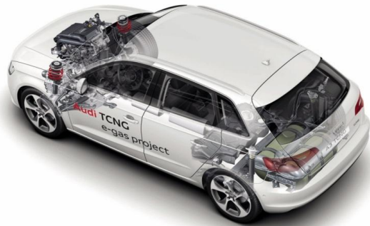
Fot. Audi A3 g-tron. Fabryczna instalacja zasilania CNG
