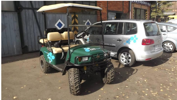
Fot. Wózek golfowy na CNG zbudowany przez firmę Vitkovice-Milmet
