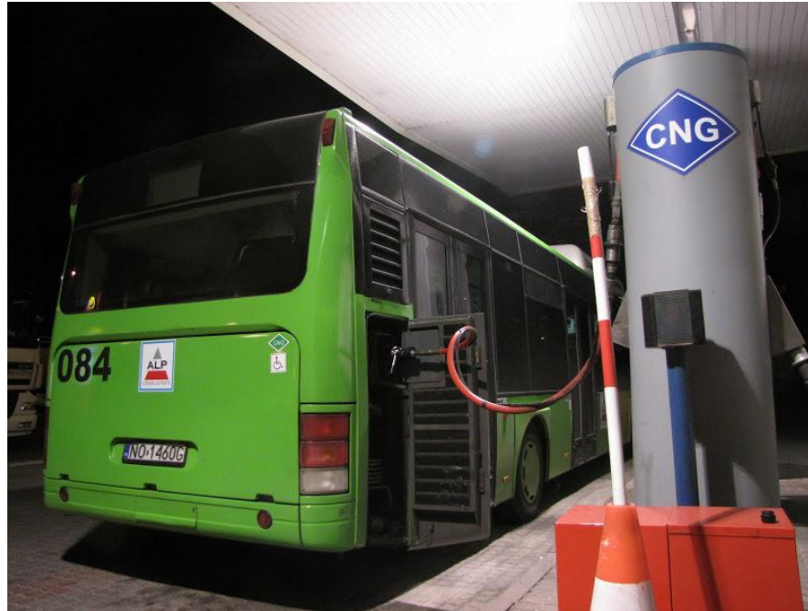
Fot. Tankowaniu autobusu CNG w Elblągu
