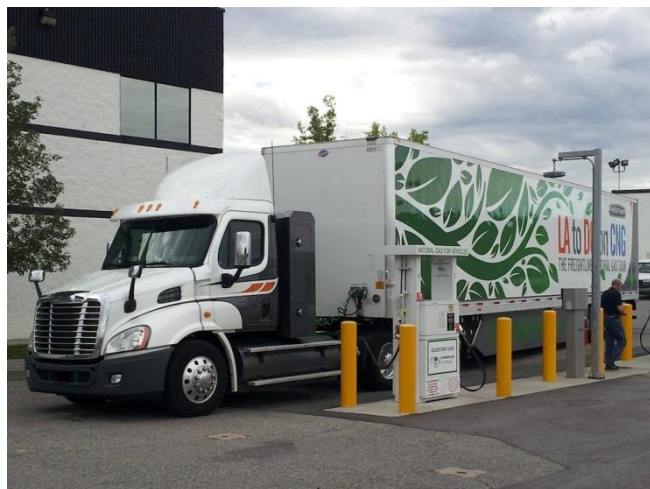
Fot. Ciężarówka Freightliner Cascadia na CNG. Pierwsza ciężarówka z silnikiem gazowym o mocy 400 KM
