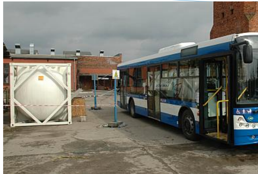
Tankowanie autobusu z prowizorycznego kontenera kriogenicznego.
