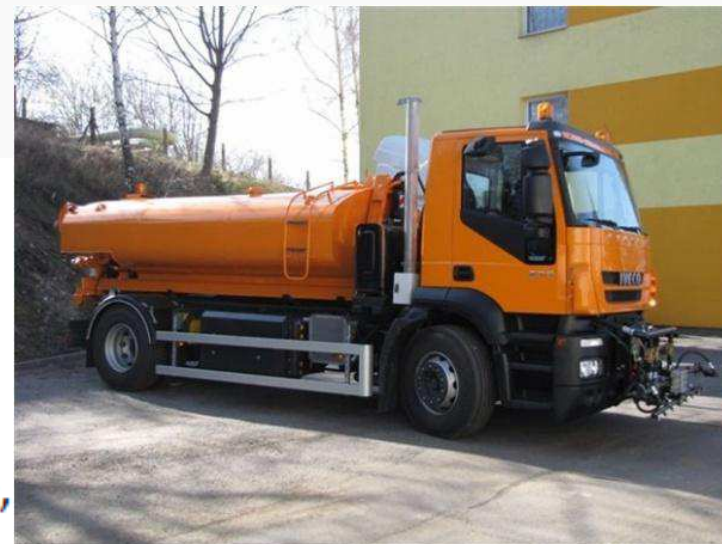
Pojazd usług komunalnych na CNG
