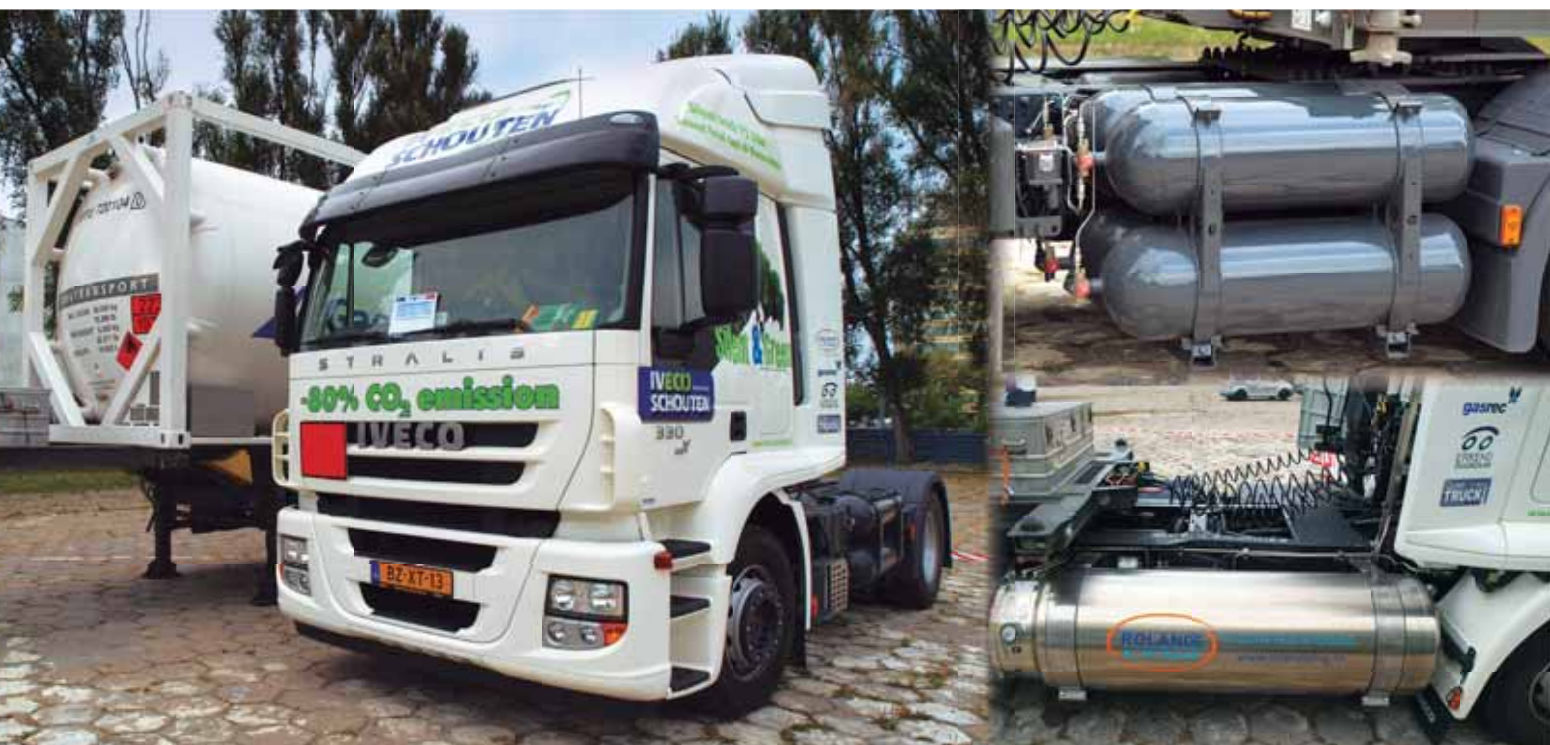
Ciągnik siodłowy Iveco Stralis wyposażony w zestaw butli z CNG po jednej i zbiornik LNG po drugiej stronie ramy. Z punktu widzenia przebiegu spalania w silniku stan skupienia gazu jest bez znaczenia.
