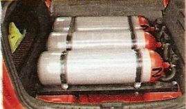
Zestaw butli zajmuje dużo miejsca, ale nie zapewnia oszałamiającego zasięgu
